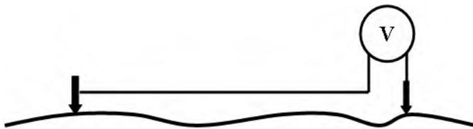
Рис. 3.1.2. Электроразведочная установка для измерения естественного электрического поля
